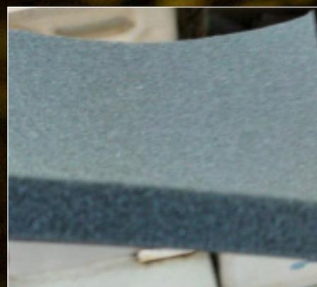
Une pièce en mousse compressée et préformée est insérée au niveau des épaules. Mousse à mémoire de forme, elle assure une protection, un confort et une tenacité lors de la l'utilisation de A.R.I (appareil respiratoire individuel).
