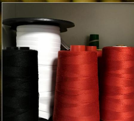
Fils en aramide de qualité thermostable à usage technique pour la protection mécanique et thermique des vêtements (vestes approche-feu).
