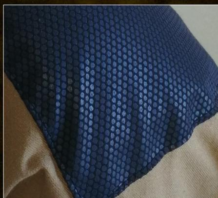
Les renforts aux épaules, coudes, genoux et bas de pantalon sont respirants et préformés cela permet une stabilité dimensionnelle et ajoute du confort au porteur. Fabriqué en Kevlar ils sont résistants à la perforation et à l'abrasion.
